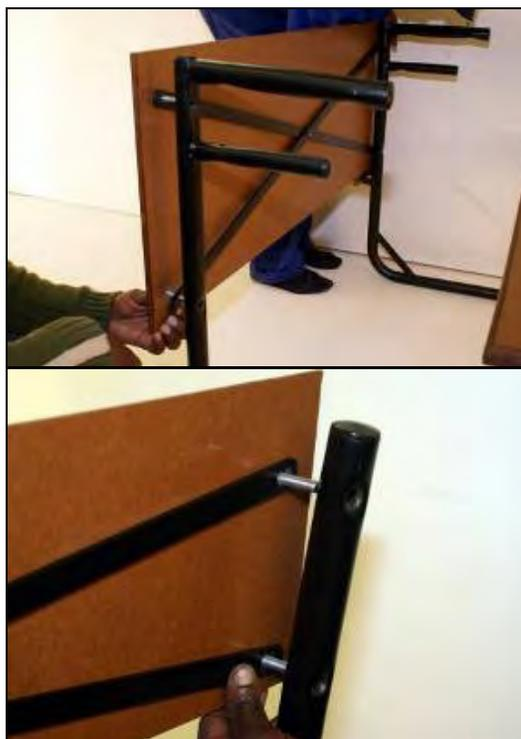
Les bancs sont livrés démontés et s'assemblent avec 18 boulons fixés avec des écrous de type autobloquant Nylock™. Au droit des trous percés dans l'armature, une légère dépression dans le tube permet de recevoir l'écrou de 13mm et d'assurer encore un meilleur blocage. 4 longueurs de boulons différentes sont nécessaires et sont fonction du diamètre des tubes et de l'épaisseur des planches. Il est nécessaire que le boulon ne dépasse pas de l'écrou de façon à ne pas blesser les utilisateurs.
