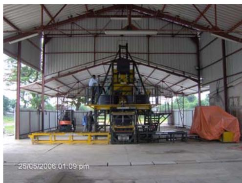
*Usine de fabrication de pavés autoblocants en béton en cours d'installation à Limete par l'Hôtel de Ville de Kinshasa*
